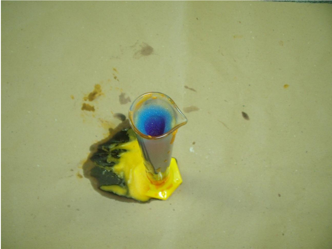
Figura 8: Resultado da pratica de pasta de dente de elefante que basea-se na reação de decomposição do peróxido de hidrogênio com o uso de catalisador (iodeto de potássio).
