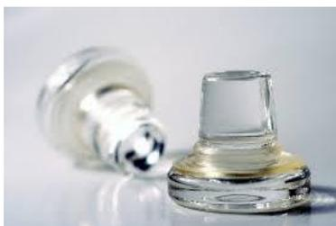
As **rolhas de vidro** são usadas para fechamento do balão volumétrico, com a mesma função da rolha de poli.
