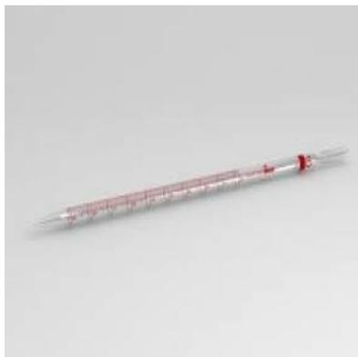
A pipeta é um instrumento de medição e transferência rigorosa de volumes líquidos. As **pipetas graduadas** possuem graduações ao longo de seu corpo, possibilitando a sucção de variadas quantidades de líquido.
