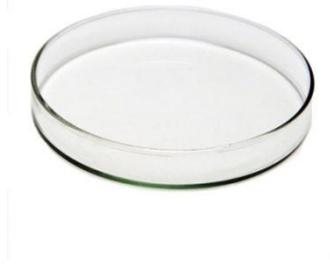
A **placa de Petri** é um recipiente cilíndrico, achatado, de vidro ou plástico usado para a cultura de micróbios. Normalmente, para se usar em microbiologia, a placa é parcialmente cheia com um caldo líquido de ágar onde estão misturados alguns nutrientes, sais e aminoácidos, de acordo com as necessidades específicas do metabolismo do micróbio a estudar
