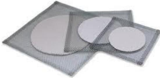
A **tela de amianto** é indicada para distribuição uniforme do calor durante o aquecimento por bico de Bunsen, ou aquecedores elétricos, a tela de amianto é utilizada como apoio a materiais de laboratório para garantir os melhores resultados em experiências e análises.
