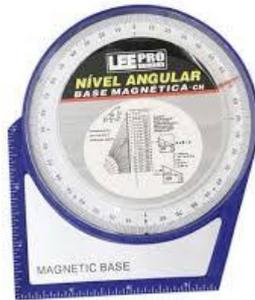
O **nível** angular é base magnética 0-90°, corpo plástico. Pode ser usado junto com o esquadro normal para obter ângulo em áreas maiores, como paredes. Nível Angular com base magnética. Medida rápida e precisas com ângulos de 0° a 90°. Base magnética para trabalho em superfícies metálicas. Este inclinômetro pode ser utilizado junto a um esquadro normal, para obter um ângulo em áreas maiores, exemplo paredes.
