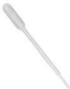
A **Pipeta de Pasteur** é utilizada geralmente para pingar líquidos em outras substâncias. Uma pipeta bastante simples, não possui abertura superior, apenas a inferior para entrada de líquido. Possui na ponta um "balão" que quando pressionado expelle o ar para fora. Daí mergulha-se a ponta no líquido e em seguida soltando o balão, trazendo o líquido para a pipeta. Geralmente são feitas de plástico e são descartáveis.
