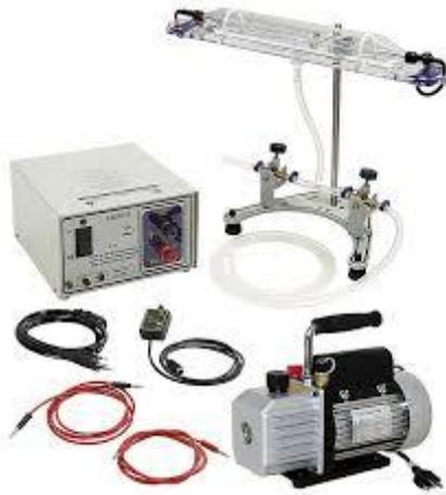
Estudo de A emissão luminosa provocada pela alta tensão elétrica num tubo de Geissler rarefeito. A interação de campos magnéticos com a descarga elétrica em gases rarefeitos. A cor da luz emitida no interior do tubo de Geissler depende do gás confinado, etc.
