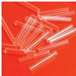
O **tubo de Durham** é utilizado em microbiologia para detectar a produção de gás por microorganismos. Eles são simplesmente pequenos tubos de ensaio inseridos de cabeça para baixo em outro tubo de ensaio. Este pequeno tubo é inicialmente preenchido com a solução em que o microorganismo é para ser cultivado.
