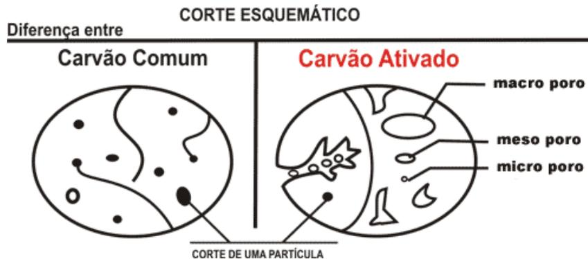
O **carvão ativado** é um material de carbono com uma porosidade bastante desenvolvida, com capacidade de coletar seletivamente gases, líquidos ou impurezas no interior dos seus poros, apresentando, portanto um excelente poder de clarificação, desodorização e purificação de líquidos ou gases.
