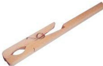
A **Pinça de madeira** é usada para segurar tubos de ensaio durante o aquecimento direto no bico de Bunsen, evitando assim queimaduras.
