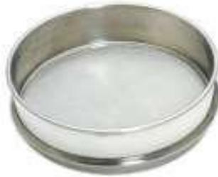
As **peneiras granulométricas** são essenciais para os processos voltados para a extração em síntese. É com elas que é feita a análise granulométrica, estudo que permite identificar o tamanho e a distribuição dos grãos e, junto à composição mineralógica, permite obter o “grau de liberação”.
