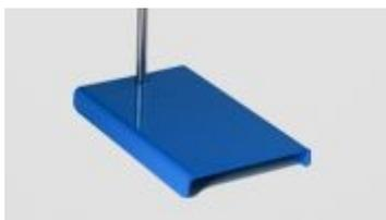
A **Base metálica para suporte universal** é uma base estável (retangular ou triangular), onde é colocado o ferro do suporte, e juntos servem para a sustentação de peças de laboratório.
