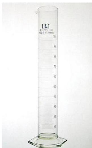
A **proveta** é um instrumento cilíndrico de medida para líquidos. Possui uma escala de volumes pouco rigorosa. Pode ser fabricada em vidro ou plástico, com volumes que normalmente variam entre 5 e 2000 mililitros. Para a medida de volumes mais precisos e exatos, é preferível o uso das pipetas.
