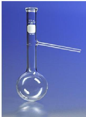
O **balão de destilação** é uma vidraria utilizada em laboratórios com principal objetivo de conter algum líquido (mistura) que será levado à ebulição para que o componente mais volátil seja completamente vaporizado e posteriormente destilado.
