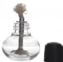
A **Lamparina em vidro** é um equipamento usado para aquecer sistemas de pequenas dimensões que requerem pouco calor. Consiste num reservatório, onde é colocado um líquido combustível. Nele mergulha um cordão por onde o líquido sobe por capilaridade, para ser queimado na outra extremidade (pavio). A temperatura da chama desta lamparina depende do combustível líquido que é utilizado.
