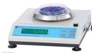
A **Balança Eletrônica de Precisão**, usada na preparação de amostras para análises e para método de determinação de medição de massa.
