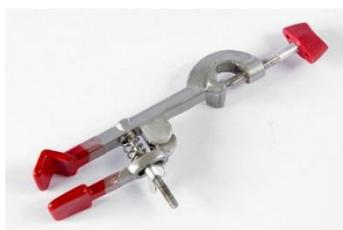
A **garra para suporte universal** é usada para segurar e sustentar vidrarias, como balões e condensadores, entre outros
