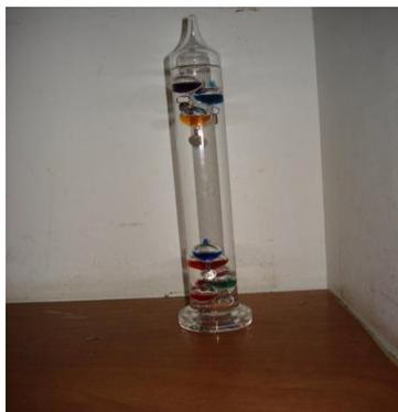
O princípio usado no **termômetro de Galileu** é que a densidade de um líquido muda de acordo com a sua temperatura. Quando a temperatura aumenta as esferas de vidro afundam e quando a temperatura abaixa as esferas de vidro flutuam. (Faixa de Temperatura Limitada de 18°C até 26°C).
