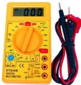
O **Multímetro** digital é um equipamento eletrônico que serve para medir (aferrir) grandezas eletrônicas. Utilizado na bancada de trabalho (laboratório) ou em serviços de campo, incorpora diversos instrumentos de medidas elétricas num único aparelho como voltímetro, amperímetro e ohmímetro por padrão e capacitímetro, freqüencímetro, termômetro entre outros, como opcionais.
