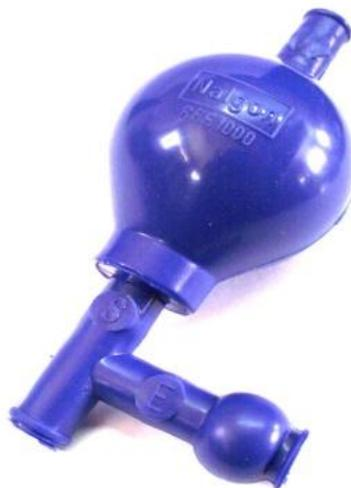
A **pera de sucção** é geralmente feito de borracha, e serve para sugar produtos químicos e biológicos em outros instrumentos (geralmente usa-se pipeta graduada ou pipeta volumétrica) sem, assim, ter contato direto com o usuário.
