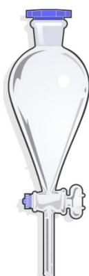
O **funil de decantação/separação** tem função de separar uma mistura líquida heterogênea por simples ação da gravidade: o componente líquido mais denso tende a ocupar a região inferior e, portanto, pode ser removido por método de dreno ( o funil de bromo possui um regulador de vazão no fundo que ao ser aberto deixa o líquido mais denso fluir).
